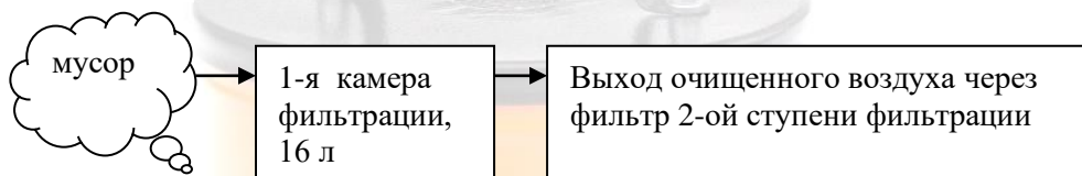
Рис. 2. Структурная схема системы очистки пылесоса
